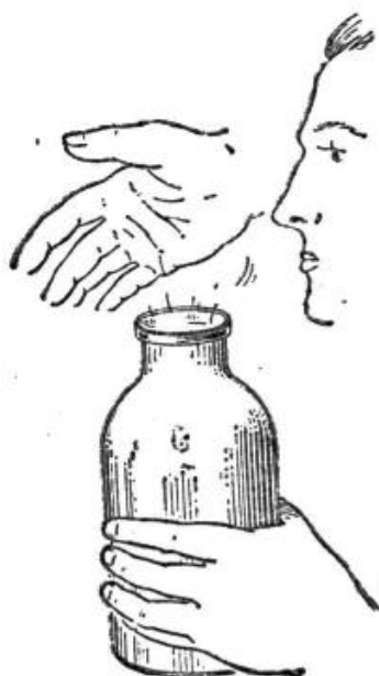
Рис. 126. Прием для обнаружения по запаху неизвестного газа.
